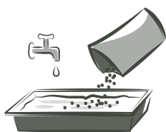
Verser la Chaux Colorée® dans l'eau : 0,75l d'eau pour 1 kg de chaux
